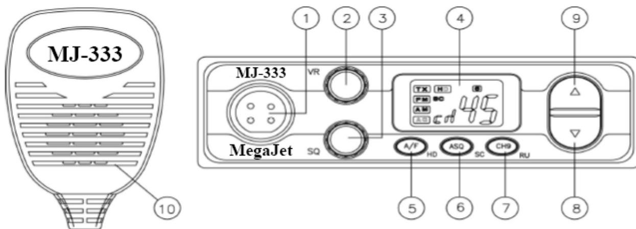
Рис. 1. Органы управления и отображения MJ-333
