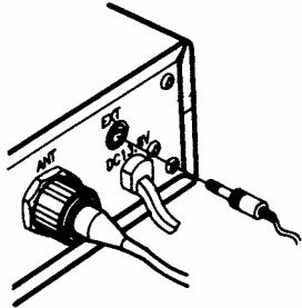
1. Вставьте микрофонный разъём в ответную часть трансивера, находящуюся на передней панели.
