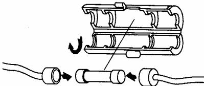
Трансивер SS-485H имеет внешний предохранитель питания на 10А и предназначен для защиты станции от перенапряжения и неправильного подключения
